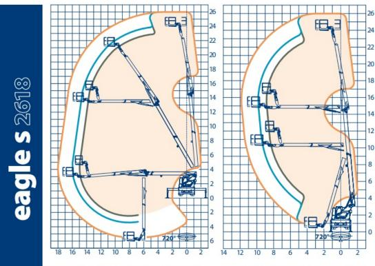
traverse totalmente aperte / totally extended supports / soportes totalmente extendidos / bequilles totalement ouverts / querträger vollständig ausgefahren / volledig open steunen / полностью разложенные аутригеры traverse chiuse / closed supports / soportes cerrados / traverses fermees / querträger geschlossen / gesloten steunen / сложенные аутригеры
